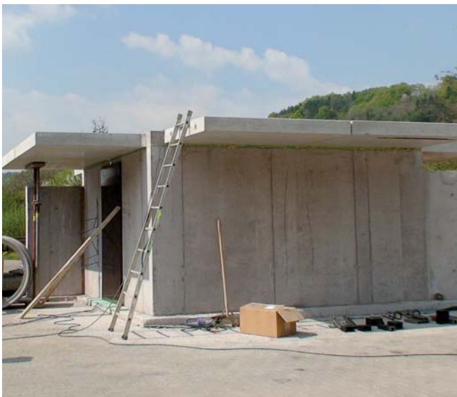
Versuchsaufbau für Trittschallmessungen Montage expérimental pour mesures de bruits de chocs
